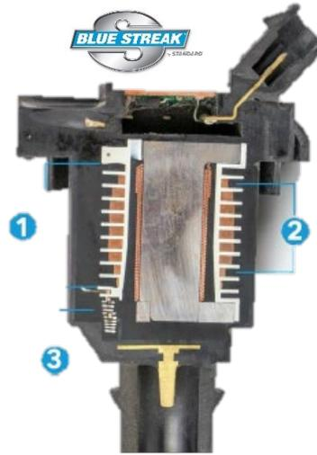
1. 10 secciones de bobinado primario, la reducción de la altura de cada una disminuye el riesgo de rotura
